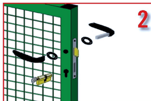
2 - Inserire la maniglia e il cilindro
